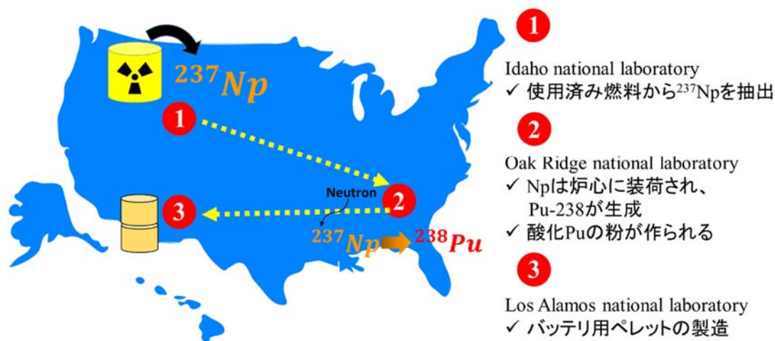
図 1.5 米国における原子力バッテリー用 Pu-238 ペレットの製造方法
