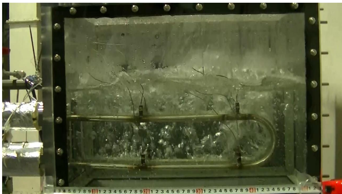
図 2.3.19 沸騰が生じている IC 水槽の様子
